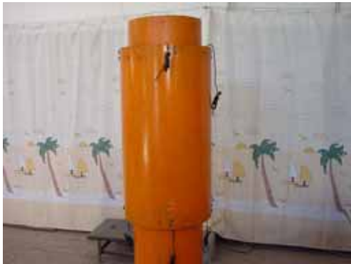
图 1 测量局部应变的套筒式结构模型
