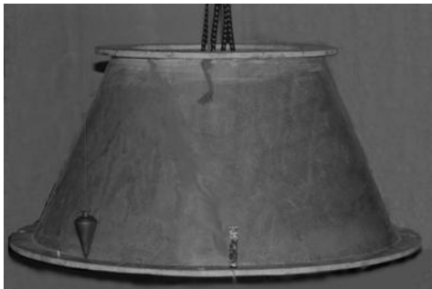
图3 锥壳结构模型
