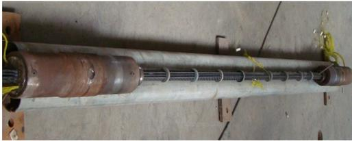
图 2 CFRP 丝股锚固体系试件
