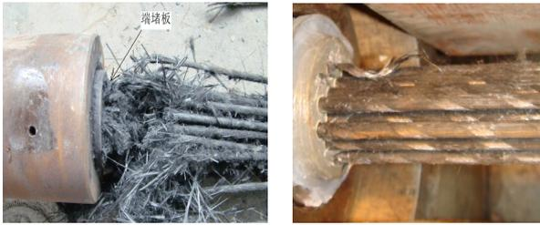
(a) 试件 NJ1 破坏形态 (b) 试件 NJ2 破坏形态
