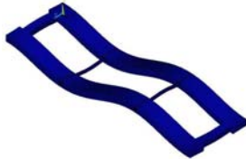
图 5 三阶振型 Fig.5 Third mode of vibration
