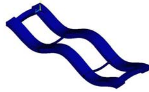
图 9 九阶振型 Fig.9 Ninth mode of vibration
