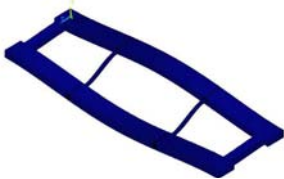
图 7 四阶振型 Fig.7 Fourth mode of vibration
