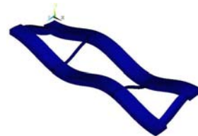
图 11 八阶振型 Fig.11 Eighth mode of vibration
