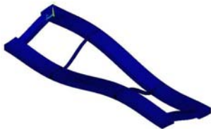
图 6 五阶振型 Fig.6 Fifth mode of vibration
