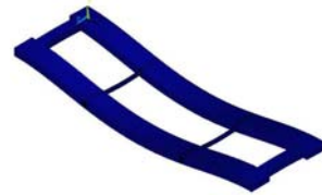
图 10 六阶振型 Fig.10 Sixth mode of vibration
