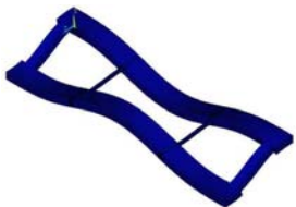
图 8 七阶振型 Fig.8 Seventh mode of vibration
