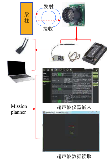
图 5 无人机系统增设超声波元件
